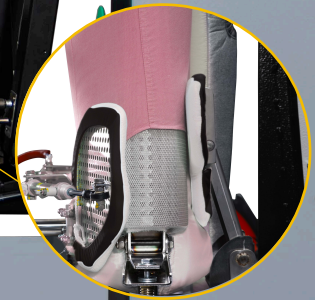
Palette frontali e posteriori per stirare perfettamente la parte inferiore della camicia
